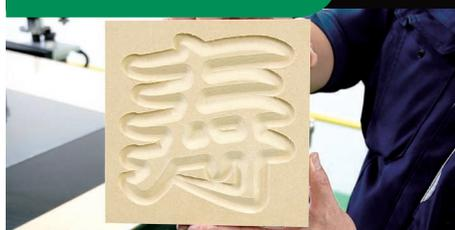
加工は文字や図形の輪郭を、カマボコの断面のように丸くするような加工です。
