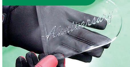
アクリル材料の切削した部分を鏡面のような仕上がりにする加工方法です。
